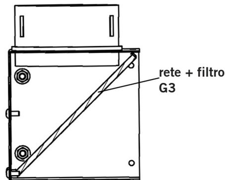
**NOTA** Gli Adattatori-Plenum della serie VMP [per tubo tondo] sono usati esclusivamente con i tubi semirigidi tondi antibatterici mod.VMLA18\*\*\*, quindi per gli impianti di VMC (Ventilazione Meccanica Controllata). **Per i tubi, nei diametri Ø63, Ø75 e Ø90, vedi anche relative Schede tecniche.**
